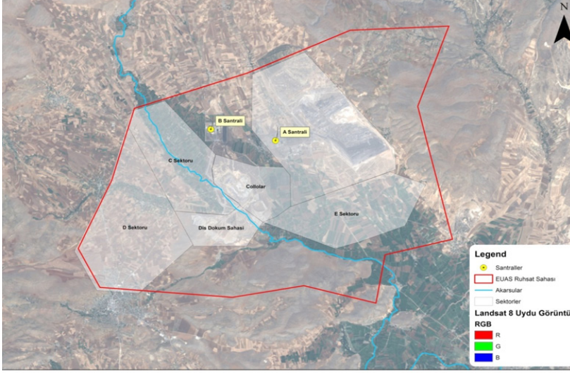
Şekil 2. Afşin Elbistan havzasından kömürün üretilmesi için oluşturulan bölgeler
